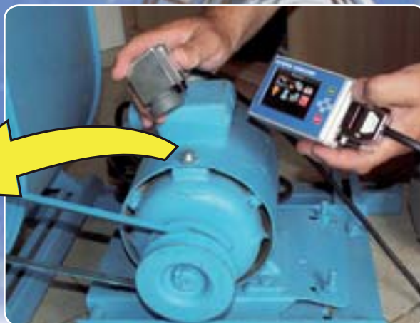
Opakovatelné uchycení snímačů rychlokonektorem na ložiskových maznicích.
