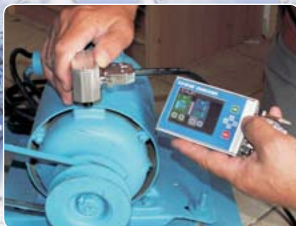
Sběrač dat s gigantickou pamětí 4 GB. Automatizace měření 5ti snímači na ložisku.
