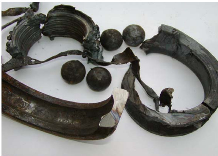
Obr. 2 Výsledok chybnjej montáže ložiska
